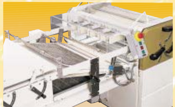
Deposito prodotti spezzati e/o filonati Divided and/or moulded piece unloading D`ep`ot produits divis`es et/ou pour pain longs Ablegen der geteilten und/oder langgewirkten Erzeugnisse
